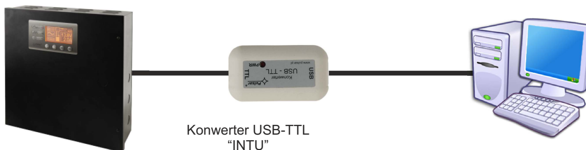
Komunikacja USB-TTL z wykorzystaniem interfejsu USB-TTL „INTU”.
