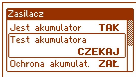
Rys. 24. Czasowe zablokowanie testu akumulatora.
