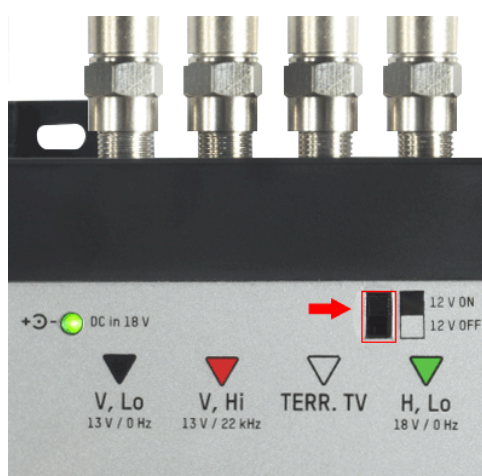
Schemat podłączenia konwertera typu quatro
