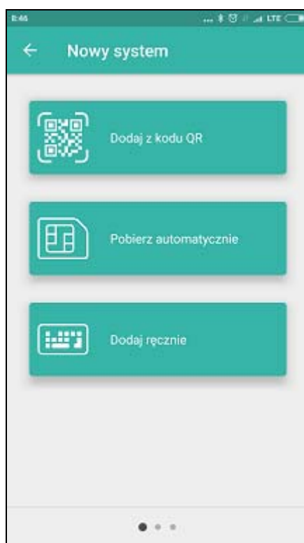
Rys. 36. Aplikacja GX Control (system Android): wybór sposobu konfigurowania ustawień dla nowego modułu.
