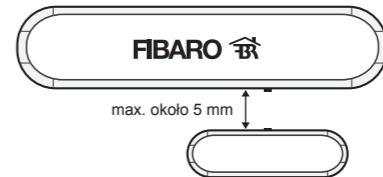
Schemat 4 - Prawidłowe ułożenie magnesu względem czujnika
