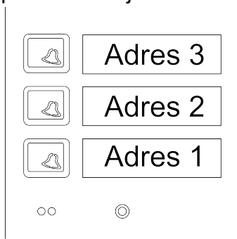
Rys. 4.6 Przypisanie adresów poszczególnym przyciskom
