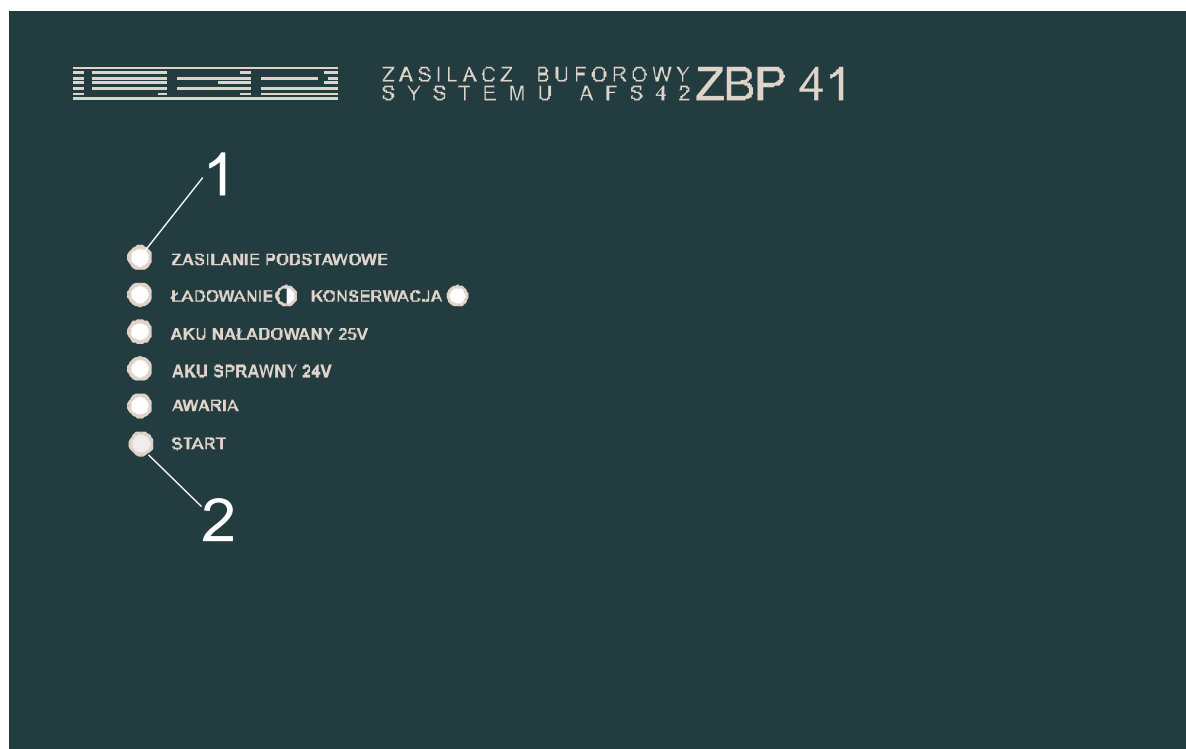
Rys. 4.2. Płyta czołowa zasilacza (1 - sygnalizatory optyczne LED, 2 - przycisk startu zasilacza, w sytuacji gdy potrzeba uruchomić zasilacz z akumulatorami bez napięcia podstawowego)
