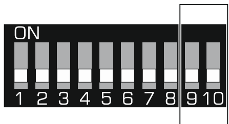
Rys. 2. Przełączniki służące do określenia trybu pracy kontrolera.
