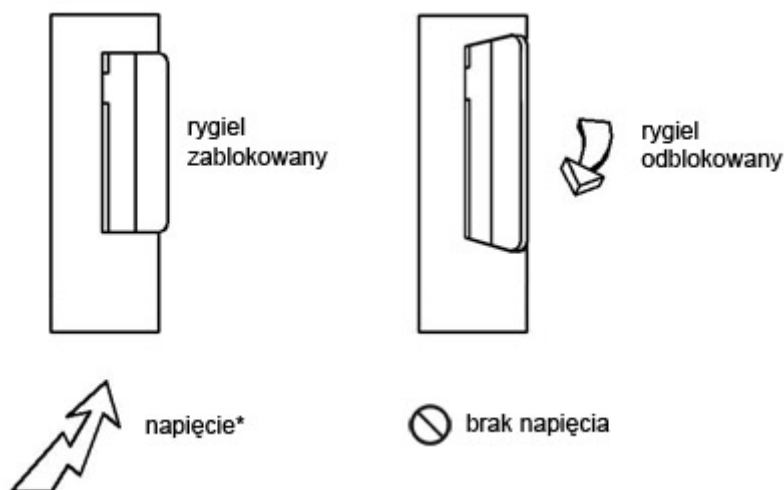
Schemat działania zaczepu rewersyjnego
