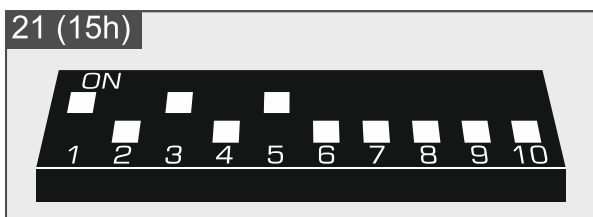
Rys. 14. Ustawienie przełączników DIP-switch w ekspanderze INT-O.
