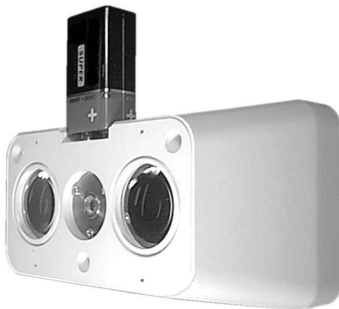
Rys 2. Czujka DOP-6001R podczas zestrainia toru optycznego
